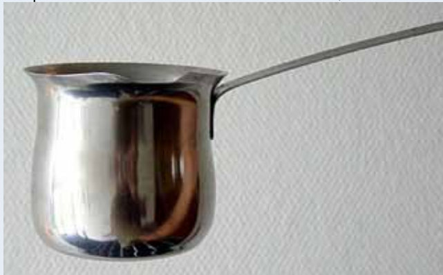
Ferritiskt rostfritt stål kan med fördel användas till produkter med tunt gods, stora materialomkostnader och enkel förarbetning. Denna kanna är i 4016 (AISI 430), ett ofta använt material inom catering. I övrigt ett utmärkt exempel på att man kan djupdra ferritiskt rostfritt stål.
