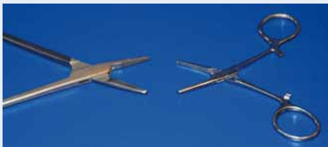
Kirurgiska instrument av martensitiskt rostfritt stål. De är hårdare och starkare än austenitiskt stål men har sämre korrosionsbeständighet.
