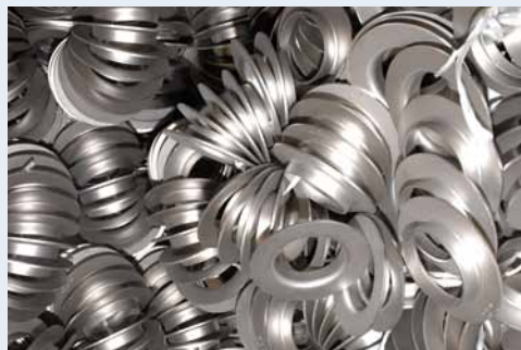
På grund av de austenitiska stålens stora töjning (> 45 %) är de är mycket duktila och därför lätta att forma. Dessa pressade kragar är tillverkade av 4404.
