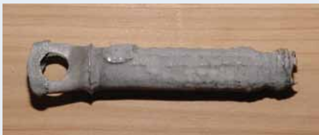
Rostfri bult, 4301, med korrosionsangrepp efter tre månader i betsyra (salpetersyra-fluorvätesyra). Observera att korrosionen är jämnt fördelad över ytan och att mängden förlorad metall är ganska hög. Trots de imponerande materiella förlusterna har ännu inte genomfrätning skett.
