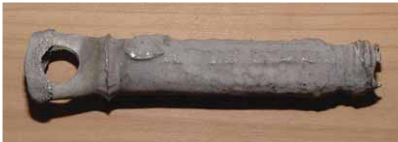
Figur 6.2: Rostfri bult (4301) efter en längre tid i stark betningssyra (salpetersyra-flusssyra). Observera att korrosionsangreppet är enhetligt och att materialförlusten är ganska stor.
